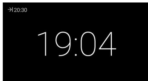
当程序达到设定时间，烤箱会自动关闭并发出提示音，按
